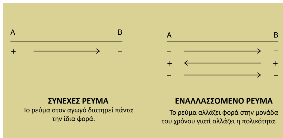
Εικόνα 3.6: Τμήμα αγωγού που διατρέχεται από συνεχές ή εναλλασσόμενο ρεύμα.
